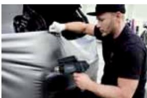
Pistola termica professionale ad aria calda, cavo 7,5 m., potenza 2.200 W, temperatura regolabile in continuo da 80 a 630 °C, regolazione del volume d'aria da 150 a 500 l/min su 3 livelli, peso 850gr.
